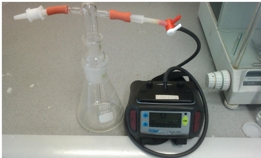
Abb. 50: Messapparatur zur Messung der Adsorption der Schadstoffe aus der Gasphase
