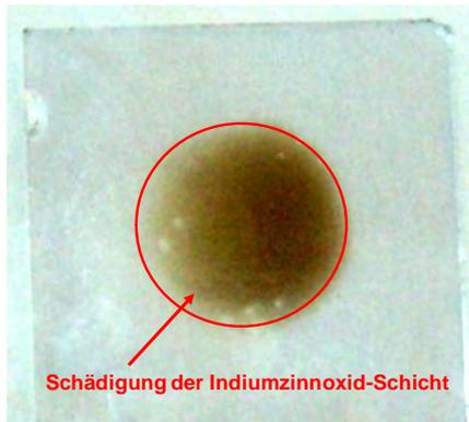
Abbildung 18: ITO nach Polarisation mit  $100 \mu\text{A}/\text{cm}^2$  für 1 Stunde im synth. TW, zentral eine metallische Abscheidung durch Reduktion des Indiumzinnoxids.
