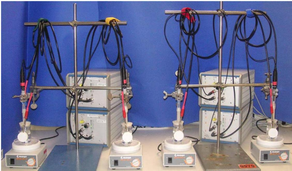
Abbildung 10: Multi-Potentiostaten-System bestehend aus vier Potentiostaten jeweils angelegt für eine elektrochemische Flanschzellen.
