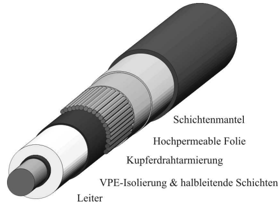
Abbildung 7.12: Modell eines Enleiterkabels mit integrierter elektromagnetischen Schirmung (SC-IES)
