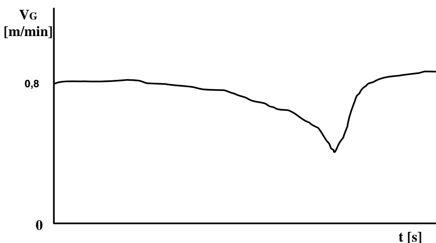
Bild 10.25: Änderung der Gießgeschwindigkeit infolge von Reibkraftänderungen
