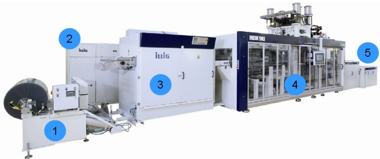
Bild 3: RDK 90-Maschine (4) mit Zustellmaschinen, wie Folienabwickleinrichtung ROK (1), Werkzeugtemperierung (2), Folienvorheizung VHW (3) und Stapelung (5). (Quelle der Fotografie: Archivbild von ILLIG Maschinenbau GmbH)
