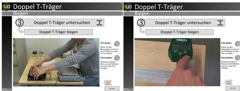
Abbildung 7.10: Screenshots des Handlungsschrittes Biegen des Doppel T-Trägers mit exemplarischer Darstellung der Teilhandlungsschritte „Profil einspannen“ und „Messuhr einschalten bzw. kalibrieren“
