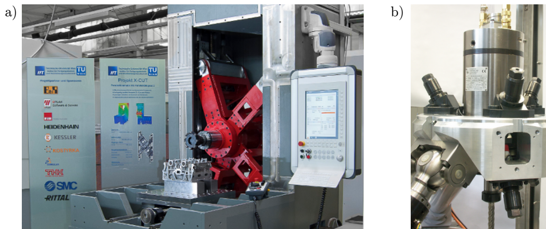
Abbildung 1.4: Redundant angetriebene Werkzeugmaschine und Arbeitsspindel: a) Redundante Werkzeugmaschine Xcut (Mit freundlicher Genehmigung von Herrn Habersohn TU Wien), b) Redundant angetriebene Werkzeugspindel (Mit freundlicher Genehmigung von Herrn Rentzsch, Fraunhofer Institut für Werkzeugmaschinen und Umformtechnik (IWU))
