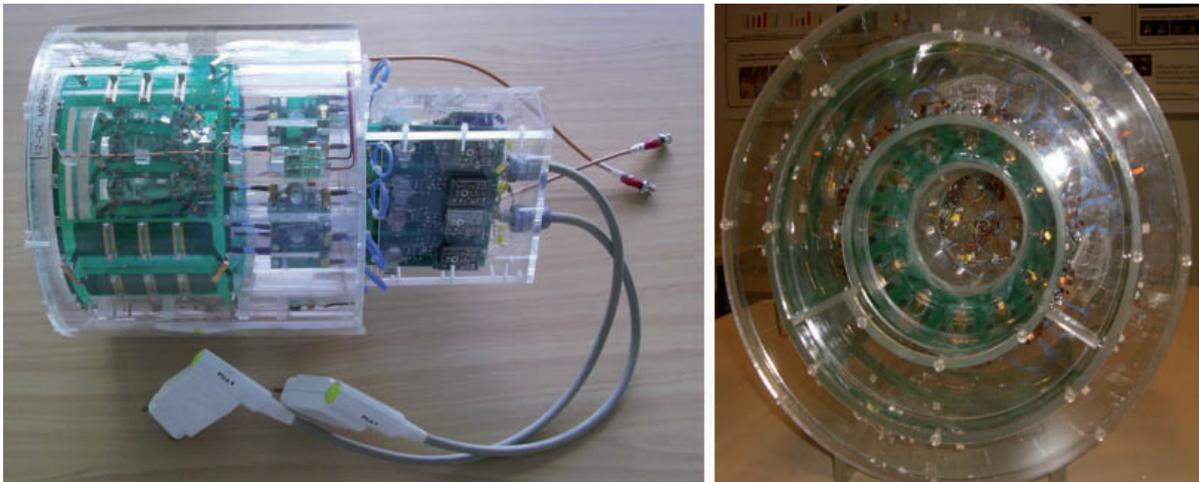
**Abbildung 5.9:** Primatenkopfspule mit Volumenspule (Tx) im Dual Helmholtz-Design und kombinierter 12-Elemente Phased-Array-Empfangsspule (Rx): (li) Gesamtansicht, (re) Frontalansicht.
