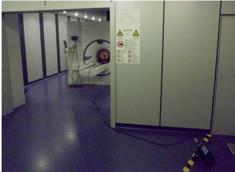
Abbildung 4.6: Messaufbau mit mobilen VNA und Patchantenne im 7 T MRT-System.
