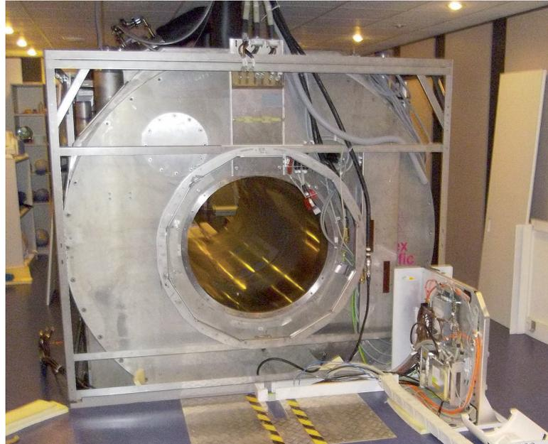
**Abbildung 3.1:** Supraleitender Magnet des Magdeburger 7 T MRT-Systems.
