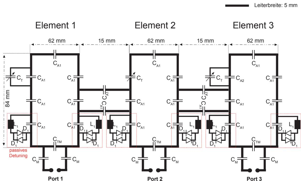
Abbildung 4.14: Schaltbild und geometrische Dimensionen der 3-Elemente Phased-Array-Primatekopfspule.
