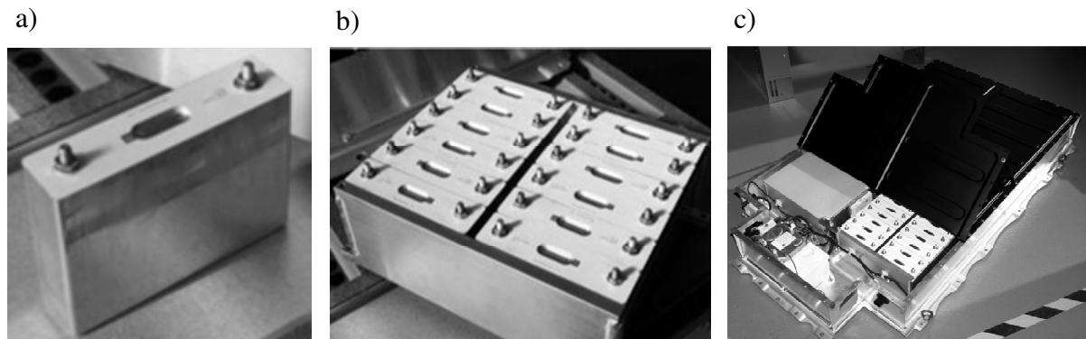
Abbildung 2.8: Aufbau des HV-Speichers: a) Zelle, b) Modul, c) Pack bzw. HV-Speicher; Bildquelle: (www.press.bmwgroup.com, 2013a)
