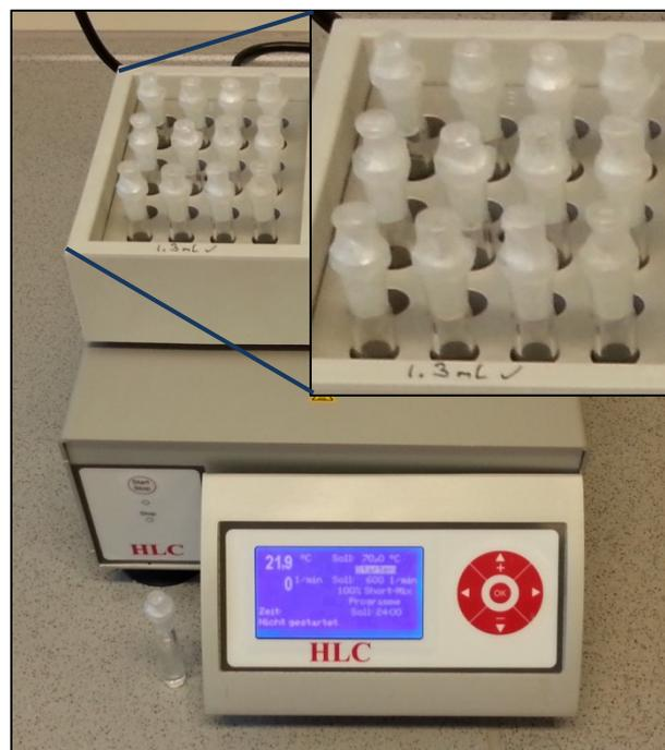
**Abb. 3.2.2:** Copolymerisation in einem HLC-Heating Thermomixer.
