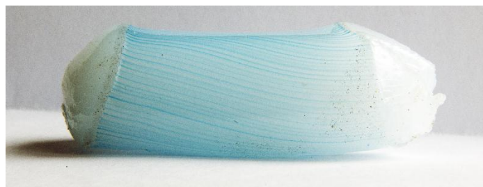
Abbildung 4-32: Probenstrang mit verbliebenem Ausgangsmaterial
