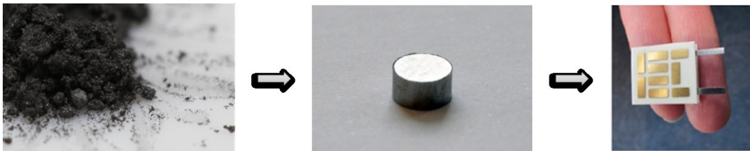
Abbildung 7: Beispiel eines Verarbeitungsprozesses bei dem TE-Nanopartikel (links) zu einem Zylinder gepresst werden (mittig), der dann als Bauteil eines TEG oder TEC verwendet wird (rechts, Bild: AiF).
