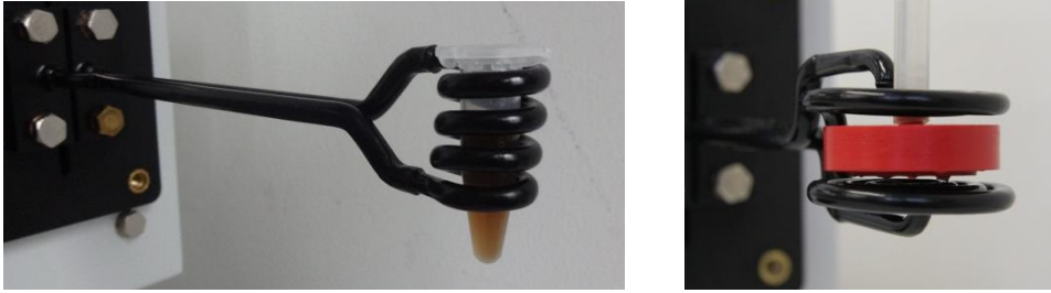
Abbildung 4.8: Vermessung der NP Dispersionen im maßgefertigten Spuleninduktor (links) und Flussmessungen der NP Membranen in einer flachen Filtrationszelle innerhalb eines Sandwichinduktors während ein hochfrequenten Magnetfeldes angelegt ist
