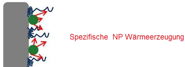
Abbildung 3.1: Schematische Darstellung der Wärmefreigebe über die NP und daraus resultierende Kollabierung der PNIPAAm-Ketten
