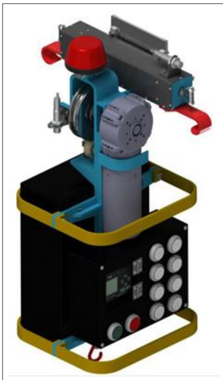
Abbildung 6.15: Laufkatze mit Steuereinheit und Bedienfeld
