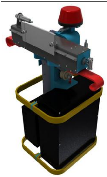
Abbildung 6.2: Darstellung der Laufkatze mit Lithium- Ionen- Akkumulator
