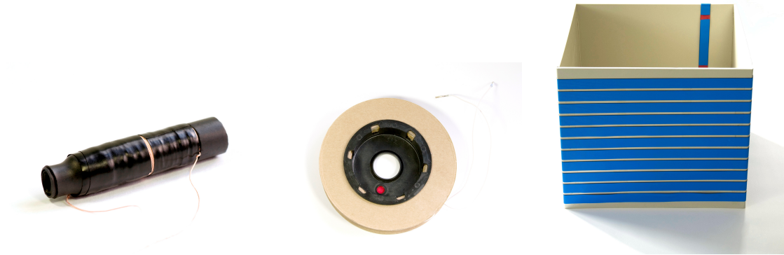
Abbildung 4.1: Lesegerätesspulen S_{LF} , S_{LL} und S_{LT} (von links nach rechts)
