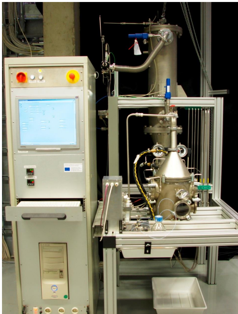
Abbildung 3-4: Sprayflammsynthesereaktor der in dem NanoEnergieTechnikZentrum (NETZ) der Universität Duisburg-Essen aufgebaut ist und betrieben wird.
