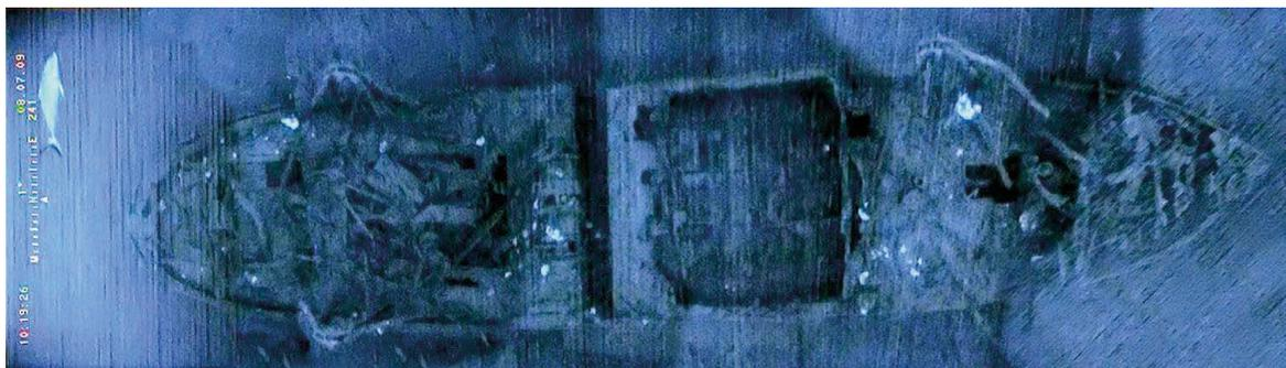
Abbildung 2.1.: Side-Scan Sonar Aufnahme vom Wrack eines Patrouillenbootes aus dem Zweiten Weltkrieg. *Quelle:* Von der U.S. Navy in [20] gemeinfrei zur Verfügung gestellt (public domain).
