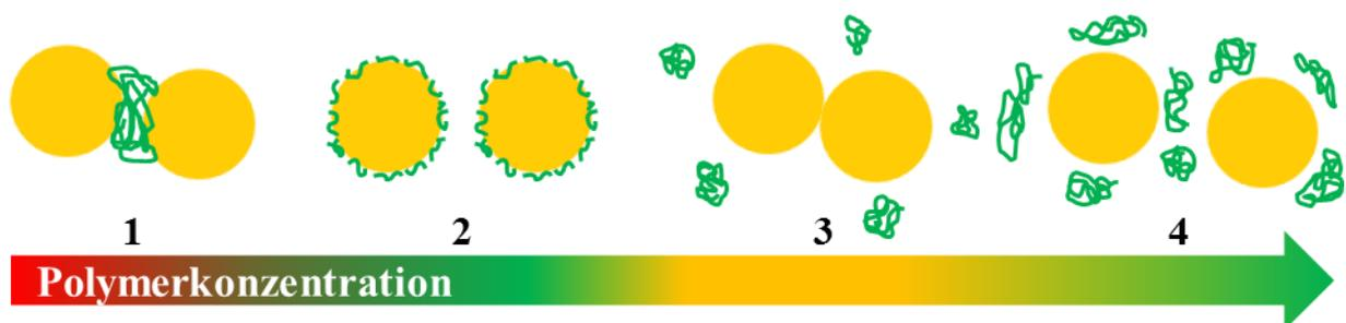
Abbildung 2.9: Schema der Darstellung der Stabilisierungen von Kolloiden in Abhängigkeit der Polymerkonzentration (1 Überbrückungsflockung, 2 sterische Stabilisierung, 3 Verminderungsflockung und 4 Verminderungsstabilisierung). [24]
