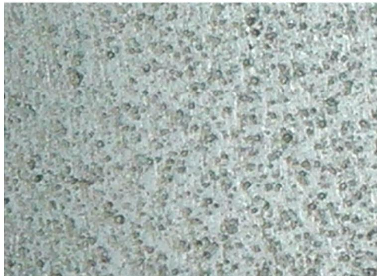
**Abbildung 4.114:** Aufnahme einer mit Mikrokapseln funktionalisierten Lackoberfläche. Deutlich zu sehen sind die z.T. großen Kapseln als „Stippen“ im Lack.
