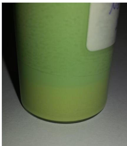
**Abbildung 4.104:** LITE 2002-Nanokapseln mit einem Phasenvolumenverhältnis von 0.25, nach optimierter Kapselsynthese hergestellt. Deutlich sichtbar ist die Sedimentation der Nanokapseln.
