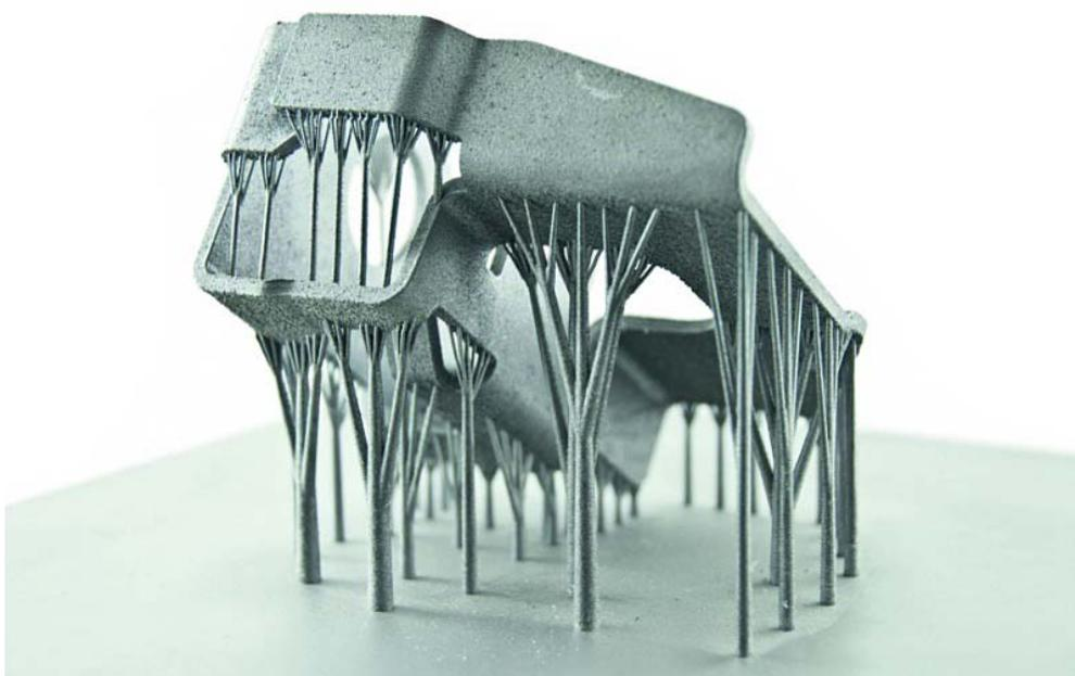
Abb. 5-14: Bauteil mit baumartigen SK (Bild: [Di13], Materialise)
