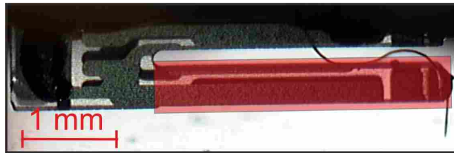
Abbildung 86: Bild eines qPlus-Sensors vom Typ RM2011 oberhalb einer Ag(111) Oberfläche. Der rot markierte Bereich wurde in der geometrischen Methode berücksichtigt. Abbildung aus [252].
