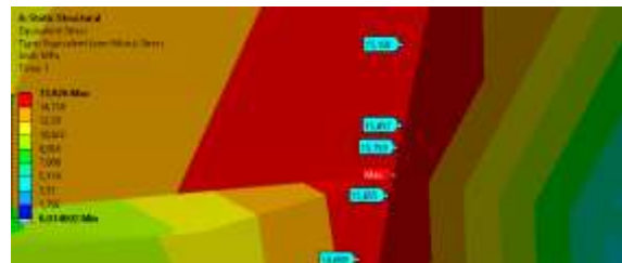
Gambar 14. Detail Sample Probe Distribusi tegangan pada shroud plate
