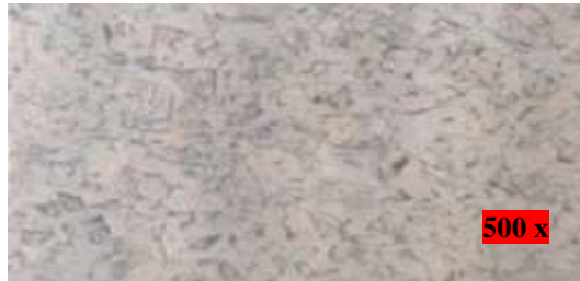
Gambar 4.8. Pengamatan pada titik 6 terlihat struktur ferrit dan sedikit perlit.
