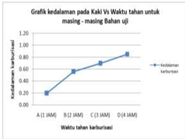
Gambar 4.27 Grafik kedalaman karburisasi pada kaki vs waktu tahan untuk masing-masing bahan uji.
