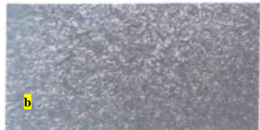
Gambar 4.1. Bahan uji dengan titik yang akan diamati (a), pengamatan pada titik 1 terlihat struktur martensit (b).
