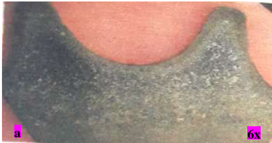
Gambar 4.16. Bahan uji yang akan diamati (a).pengamatan pada titik 1 terlihat struktur martensit halus (b).
