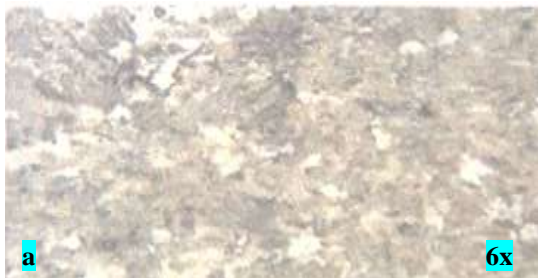
Gambar 4.14. Pengamatan pada titik 2 terlihat struktur martensit dan perlit (a), pengamatan pada titik 3 terlihat struktur bainit, sedikit ferrit dan perlit (b)
