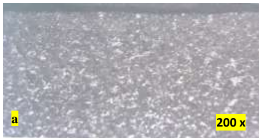
Gambar 4.3. Pengamatan pada titik 4 terlihat struktur perlit (a), pengamatan pada titik 5 terlihat struktur perlit dan ferrit (b).
