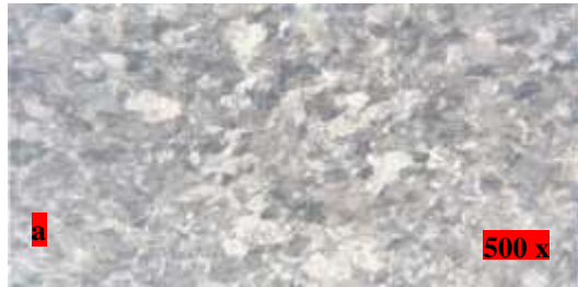
Gambar 4.7 Pengamatan pada titik 4 terlihat struktur perlit (a), pengamatan pada titik 5 terlihat struktur Bainit, ferrit dan perlit (b)
