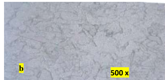
Gambar 4.1. Bahan uji dengan titik yang akan diamati (a), pengamatan pada titik 1 terlihat struktur martensit (b).
