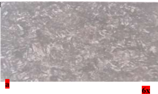
Gambar 4.21. Pengamatan pada titik 2 terlihat struktur martensit yang lebih kasar (a), Pengamatan pada titik 3 terlihat struktur ferrit mendominasi dan sedikit perlit (b).
