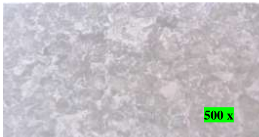
Gambar 4.12 Pengamatan pada titik 6 terlihat struktur perlit dan ferrit
