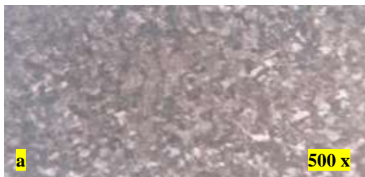
Gambar 4.2. Pada titik 2 terlihat struktur mulai bagian pengamatan atas sampai bawah martensit, ferrit dan perlit, pengamatan pada titik 3 terlihat struktur ferrit dan perlit (b).
