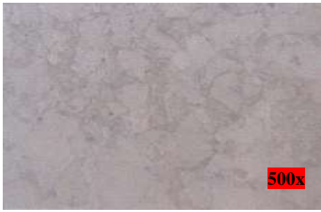
Gambar 4.23. Pengamatan pada titik 6 terlihat struktur ferrit yang dominan dan perlit serta bainit sedikit.
