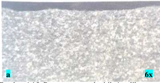
Gambar 4.15. Pengamatan pada titik 4 terlihat struktur perlit (a), pengamatan pada titik 5 terlihat struktur perlit (b).
