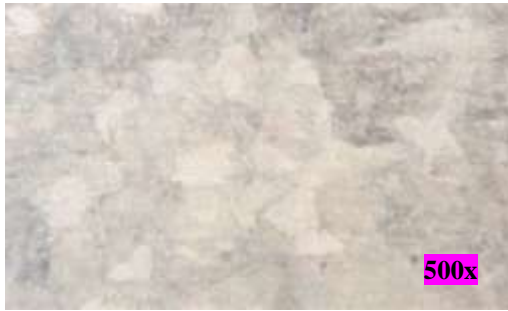
Gambar 4.19. Pengamatan pada titik 6 terlihat struktur bainit dan perlit serta sedikit martensit.
