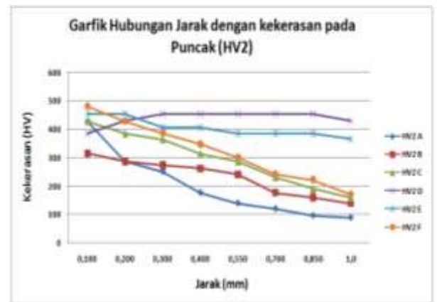
Gambar 4.26 Grafik kekerasan benda uji pada puncak (HV2) untuk perlakuan dengan jarak penjejukan
