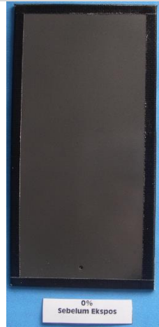
Gambar 2. Sampel uji cat akrilik bening sebelum uji kabut garam
