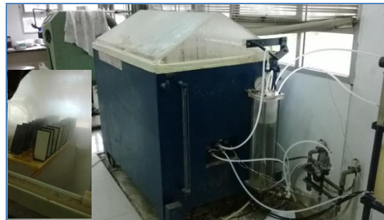
Gambar 3. Alat pengujian kabut garam dengan standar ASTM B117-97
