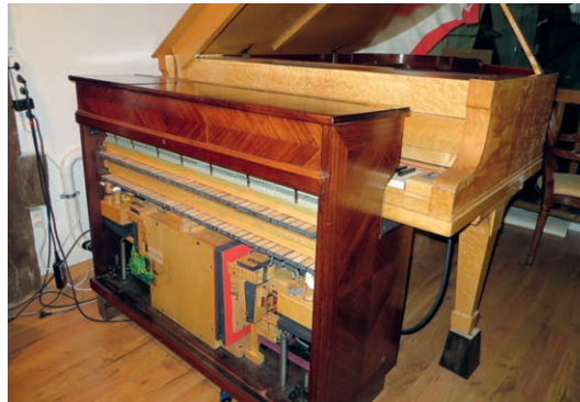
Bild 18 – Durch MIDI angesteuerter Welte-Mignon-Vorsetzer (Théâtre Barnabé, CH-1077 Servion)
