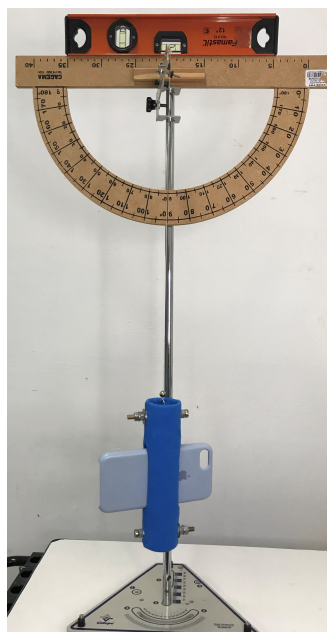
Figura 2: Montagem experimental do pêndulo simples com o aplicativo Phyphox.
