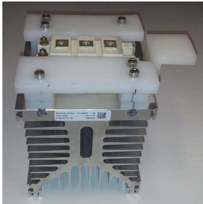
**Figura 11.1:** Fijación de soportes y módulo al radiador
