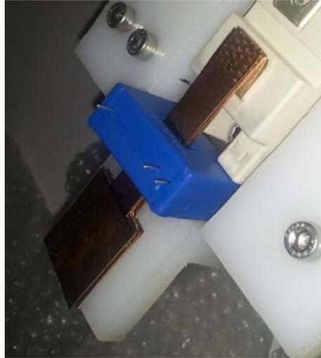
Figura 11.5: Sensor en busbar 2
