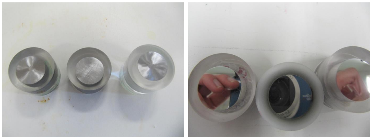
Fig 4.1-4. Probetas en etapa intermedia desbaste(izqda.) y probetas pulido finalizado(dcha)
