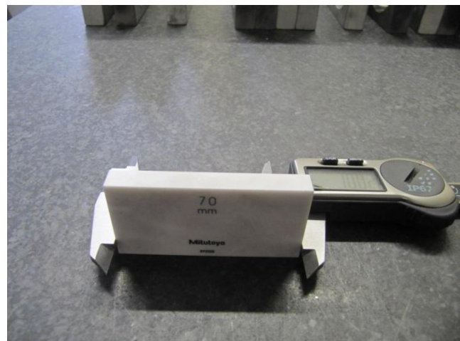
Fig 5.1-4. Calibración Pie de Rey para 70 mm
