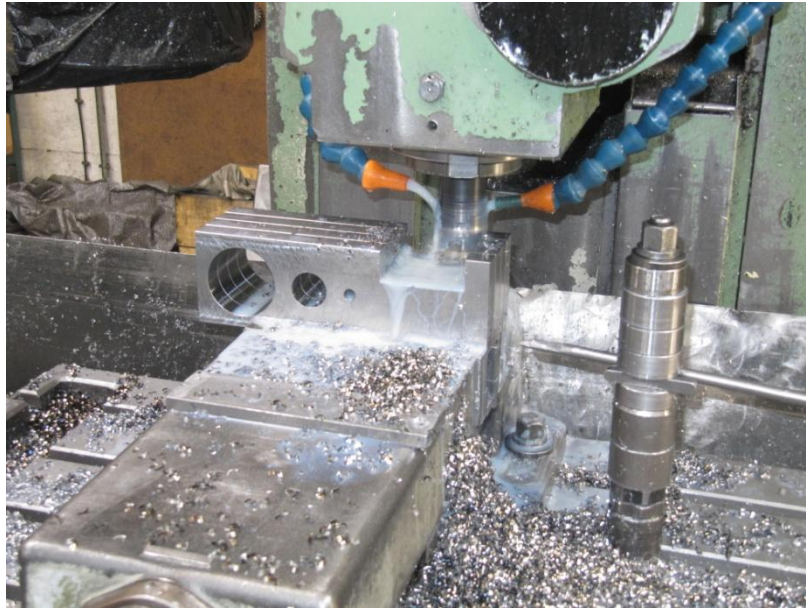
Fig 5.2-6. Desbaste defecto de masa 70x70mm Pieza 3
