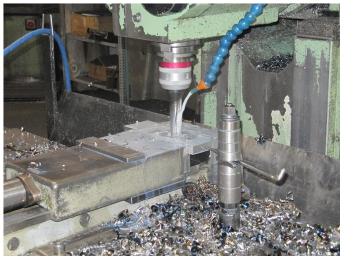
Fig 5.2-5. Desbaste taladros 30 mm Pieza 3
