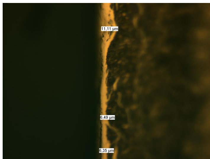
Fig A.1-58..Capa de compuestos acero X40CrMoV5-1 nitcar sales (1000x)
