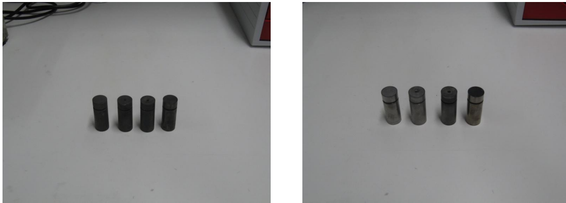
Fig. 4.2-2. Probetas nitrocarbureadas baño de sales(izqu) y nitruradas en plasma(dcha).
