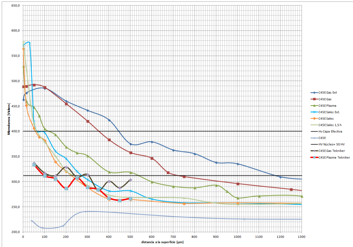
Fig 4.3-6. Comparativa microdureza C45E según proceso (incluyendo nit Tekniker)
