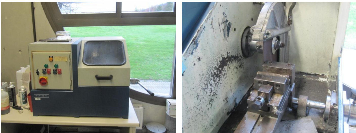
Fig 4.1-1. Máquina de corte utilizada y detalle de la misma.
