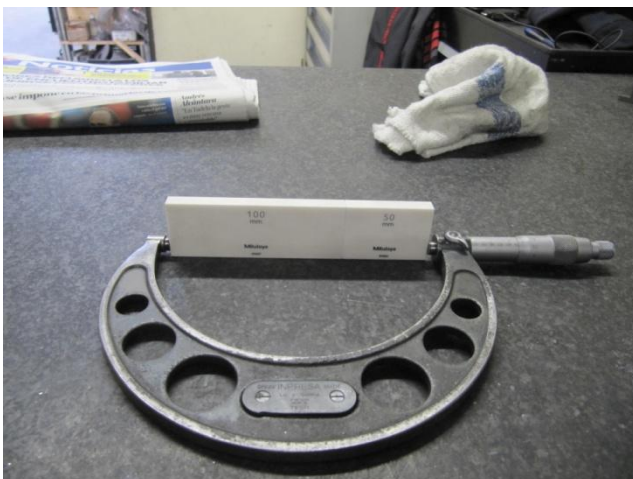
Fig 5.1-3. Calibración micrómetro exteriores para 150 mm
