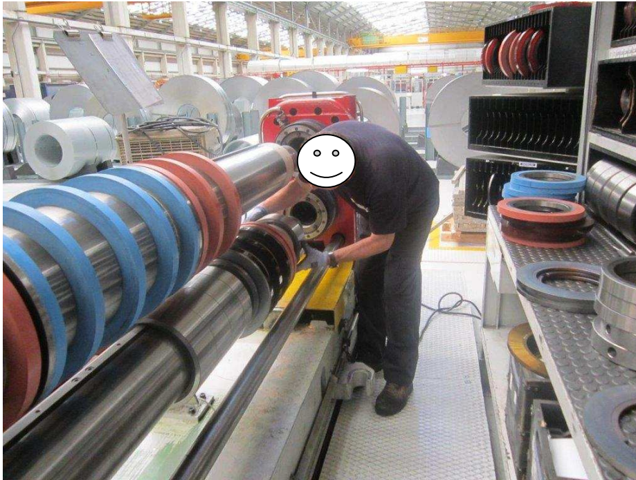
Figura 9. Operario colocando los discos de corte en el mandril
