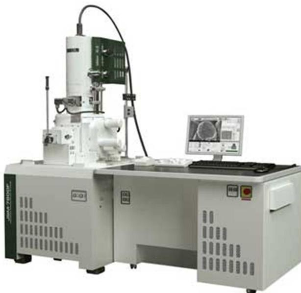
**Figura 2.9:** Imagen del microscopio electrónico de barrido JSM-5610LV empleado por el Servicio de Apoyo a la Investigación.
