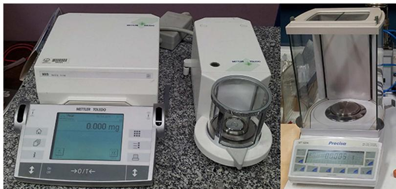
**Figura 2.5:** Fotografía de la báscula Mettler Toledo MX5 (izquierda) y la Precisa XT 120A (derecha) utilizadas.
