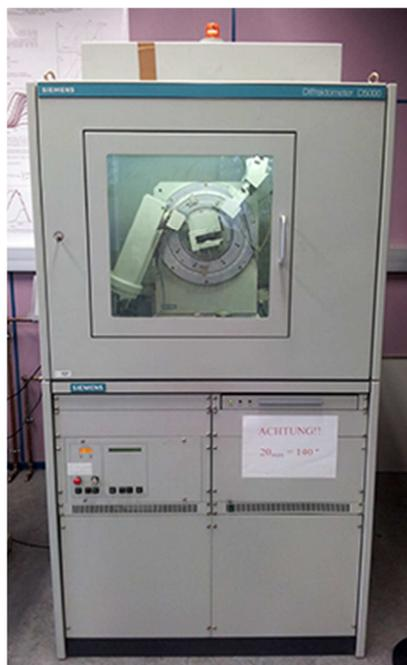
**Figura 2.14:** Fotografía del Diffraktometer D5000.
