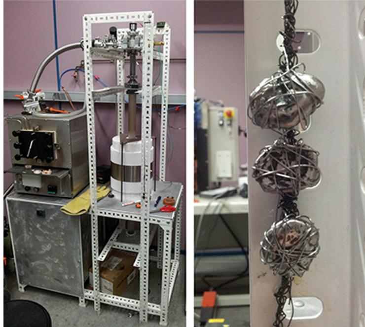
**Figura 2.8:** Fotografía del horno vertical (izquierda) y de tres muestras enrolladas en hilo de Kanthal (derecha)
