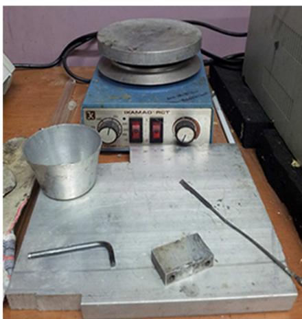
**Figura 2.2:** Fotografía de los instrumentos utilizados para la colocación de la resina. En la parte superior está el instrumento con el que se calienta, a la izquierda el recipiente de la resina y en la parte inferior el portamuestras al que se pegará la muestra.
