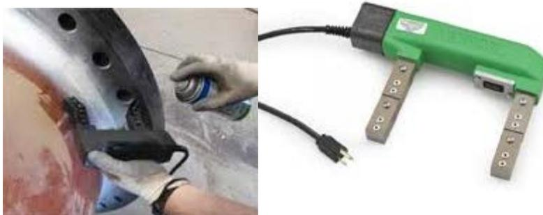
Fotos del ensayo de partículas magnéticas (con spray de contraste y el yugo).
