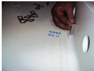
Medios de medición: O bien con un calibre tal y como se representa en la foto de debajo o bien directamente con una pequeña regla metálica.
