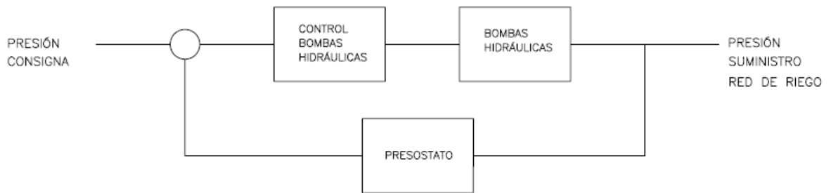
Ilustración 16 Sistema de lazo cerrado con consigna de presión
