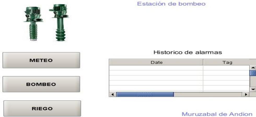
Ilustración 10 Pantalla principal SCADA
