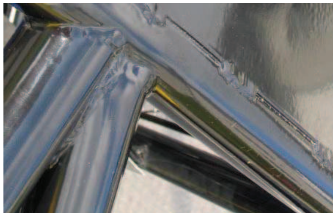
Resultado del proceso de lacado con partículas de aluminio acabado metalizado en el chasis.
