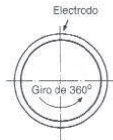
Soldadura circular de 360°.
