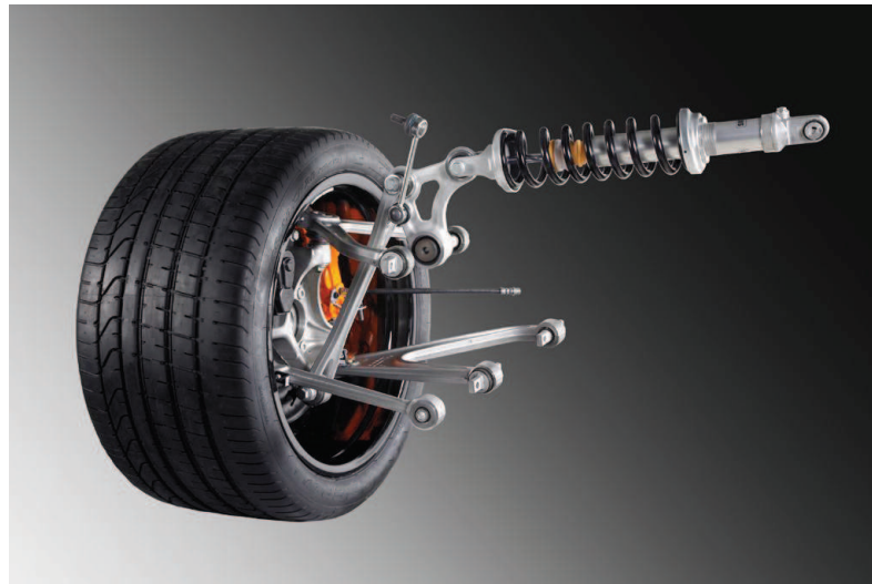
Ejemplo de sistema de suspensión tipo push-rod.
