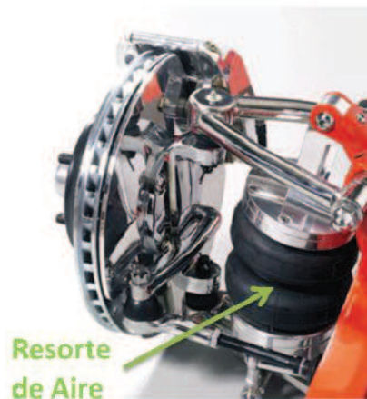
Geometría básica de un resorte de aire.
