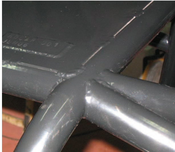
Detalle del acabado del chasis de la pintura de poliéster en polvo (sin partículas de aluminio).
