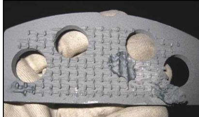
Imagen 48. Ejemplo de soporte mal encolado.
