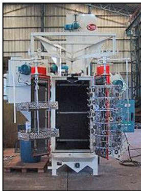
Imagen 13. Granalladora de turbinas horizontales
