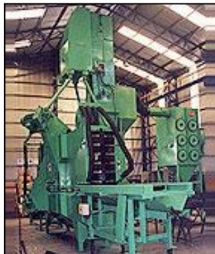
Imagen 15. Granalladora con turbinas verticales
