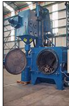
Imagen 14. Granalladora con turbinas de tambor
