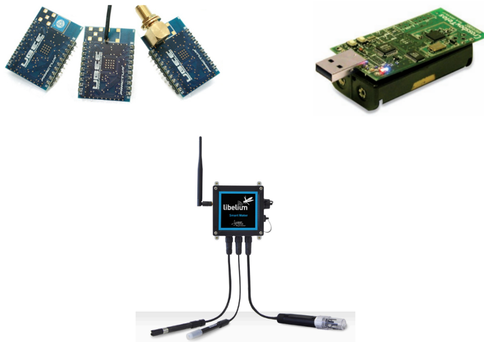
Figura 6.1: Diferntes tipos de transceptores ZigBee para redes de sensores WSN de Fractum, Telos B y libelium . Fuente [Anexo 2].
