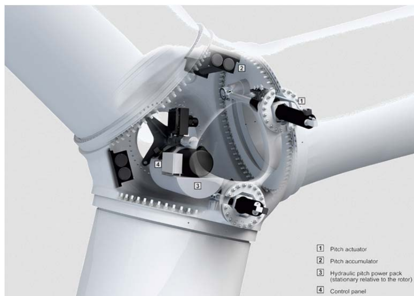
Figura 4.6: Ejemplo del control por cambio de paso
