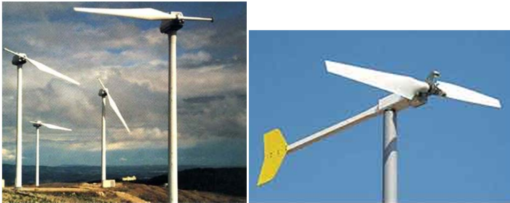
Figura 4.4: A la izquierda: Conjunto de aerogeneradores monopala. A la derecha: aerogenerador bipala
