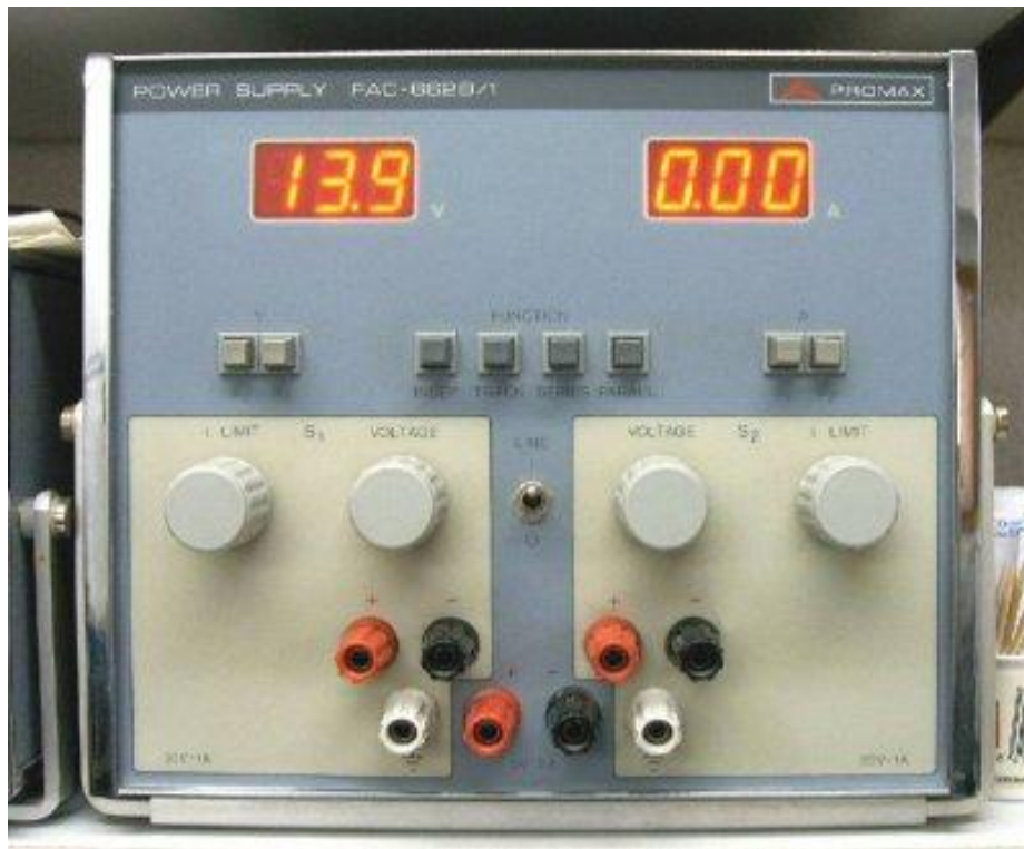
Figura 4. Simulación panel fotovoltaico mediante fuente de alimentación (Elaboración propia)
