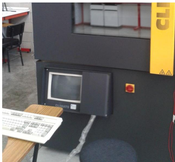
Figura 3.12. Teclado, monitor e interruptor para inicializar el programa de la cámara
