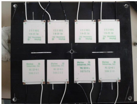
Figura 3.10. Disposición de los módulos sobre el disipador para \delta = 0,469 (8 TEM)
