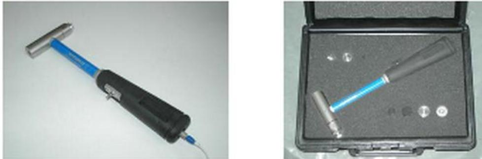
Figura 8-4. Martillo Dytran 5850A conectado y en la caja con masas adicionales y puntas.
