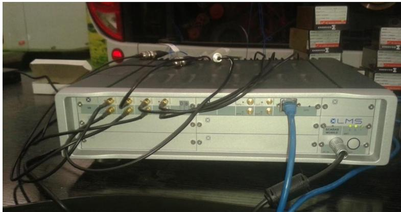
Figura 4-27. Analizador de señales SACADAS Mobile de LMS
