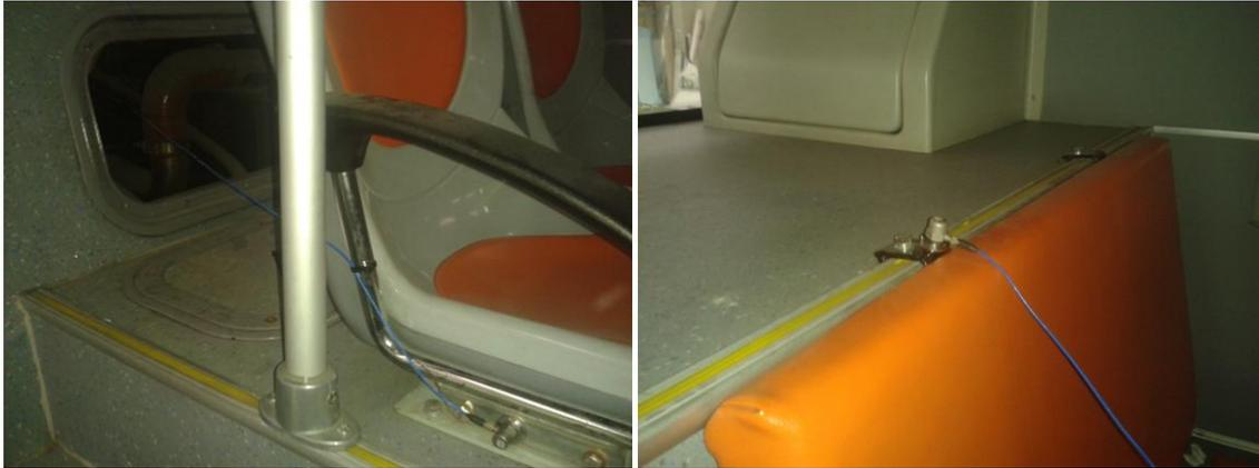
Figura 8-25. Acelerómetros colocados en el compartimento de pasajeros
