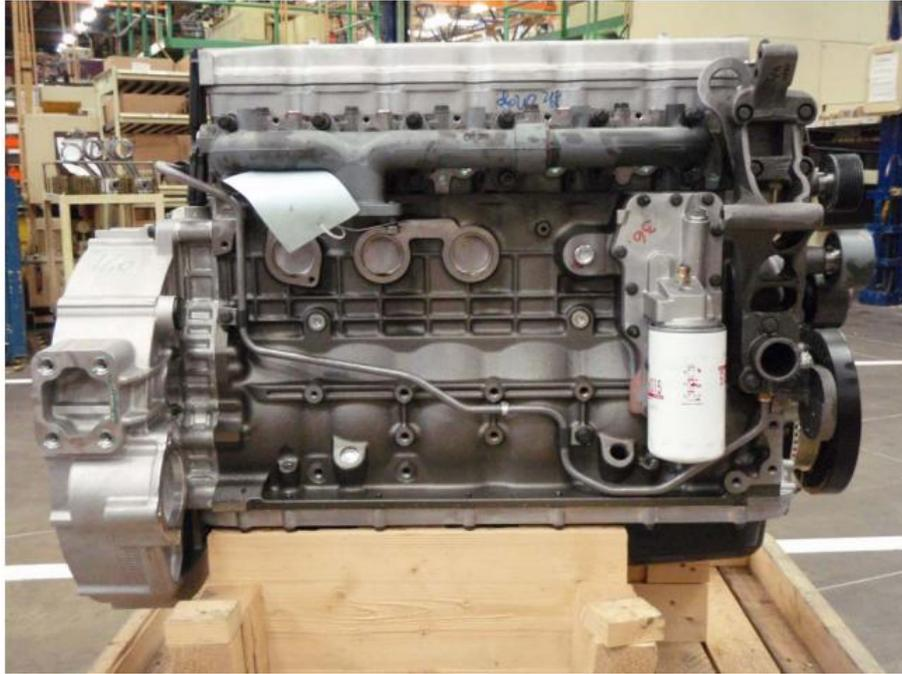
**Figura 1-5. Motor 6ISBe5 de 6 cilindros en línea**
