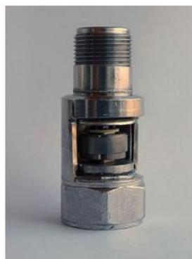
Figura 4-23. Acelerómetro piezoeléctrico
