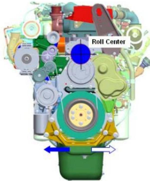
Figura 1-15. Movimientos debidos al giro del motor en soporte delantero simple.
