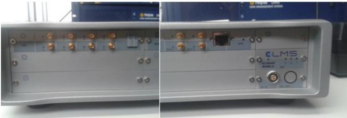
Figura 8-3. Detalles de las conexiones del SCADAS Mobile
