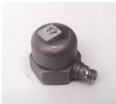
Figura 8-6. Acelerómetro real del laboratorio
