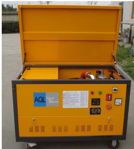
Figura 7: Grupo electrógeno a biogás. Fuente: AQL Engineering
