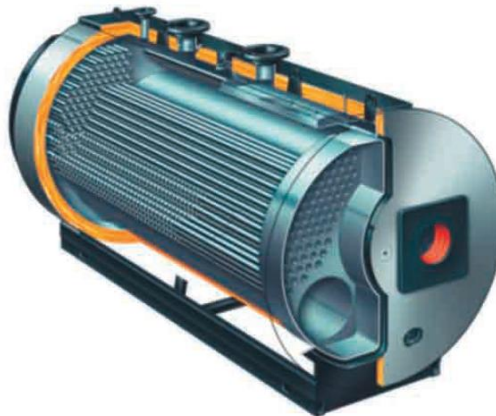
Figura 29: Caldera piro-tubular de baja temperatura. Fuente: Guía básica de calderas eficientes. Fundación de la Energía de la Comunidad de Madrid.
