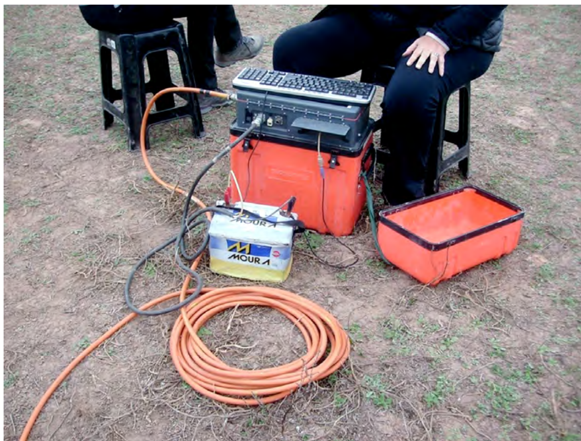
Figura 74: Logger de medición Stratagem EH4-II con una batería de alimentación de 12 volts
