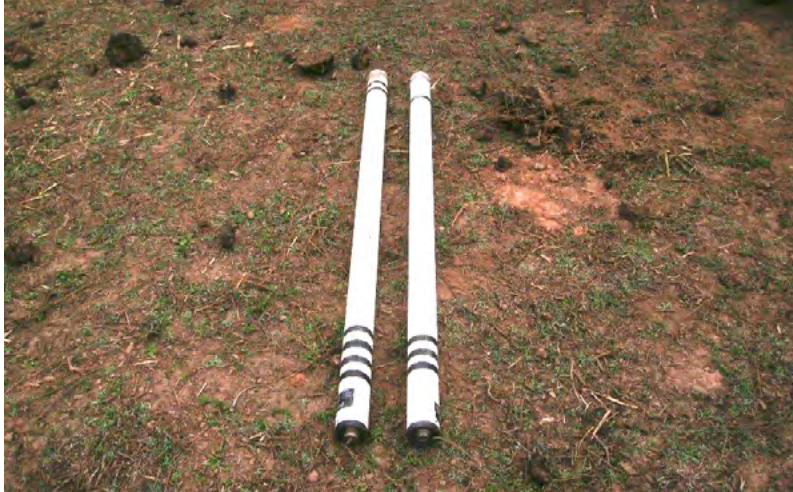
Figura 75: Barras de lectura del campo magnético de baja frecuencia. La barra izquierda está señalizada para ubicarse en sentido E-W y la barra de la derecha para una ubicación en sentido N-S.
