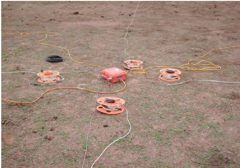
Figura 76: Nodo de conexión de los 2 sensores magnéticos (barras Hx y Hy) con orientación N-S y E-W, y los 4 dipolos (Ex e Ey) con orientación N-S y E-W
