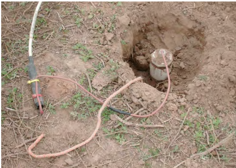
Figura 77: Electrodo impolarizable correspondiente al arreglo de registros para bajas frecuencias MT
