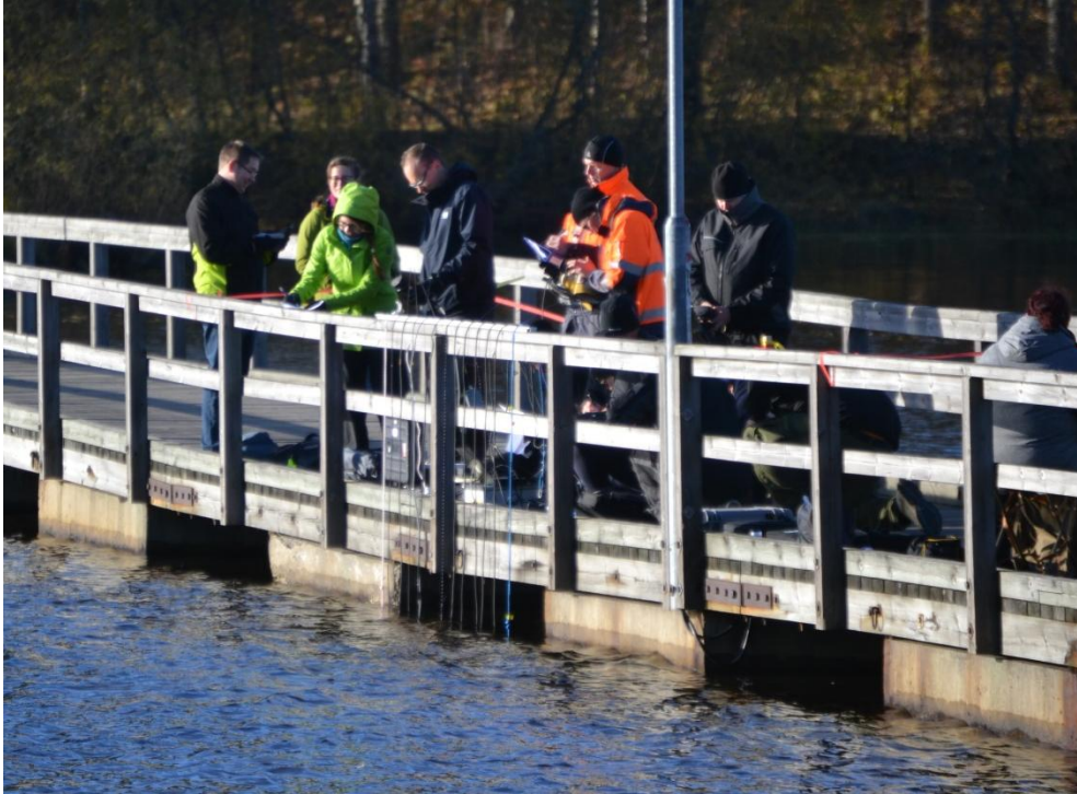
Kuva 1. Vertailumittaukseen osallistuneet kenttämittarit kiinnitettiin puusillan kaiteeseen, betoniponttonien väliin. Veden virtaus oli vähäistä, joten anturit eivät olleet vaarassa rikkoutua ponttonilaituria vasten. (Kuva T. Väisänen).
