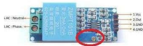
Gambar 7 Trimpot untuk Kalibrasi
