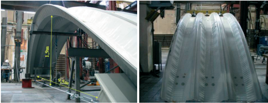
Rys. 4. Element badawczy zadaszenia łukowego ABM 240 [16]
