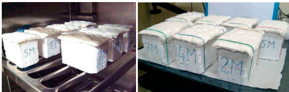
Rys. 5. Badany układ: okład z ligniny – cegła ceramiczna
