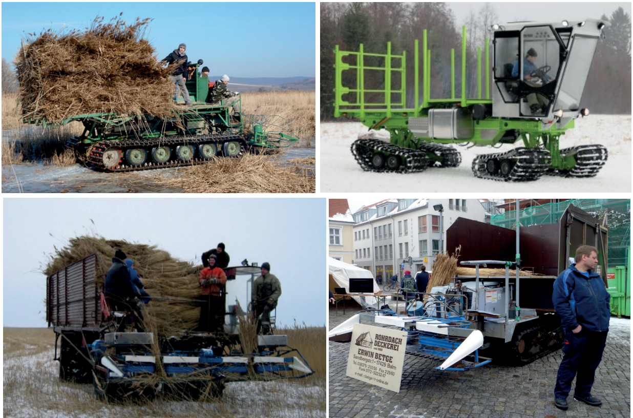
Kuva 20. Niputtavia konetyyppejä on useita. Ylärivissä vasemmalla itävaltalainen nuorta järviruokoa niputtava "Paul 1" ja oikealla virolainen 2010-luvulla kehitetty ja rakennettu Mülkameister (OÜ Kirs Engineering). Alarivissä virolainen BCS-terällä varustettu Seiga (kuva Ülo Kask 2011) ja Erwin Betgen saksalainen versio niputtavasta leikkurista Greifswaldissa vuonna 2013.
