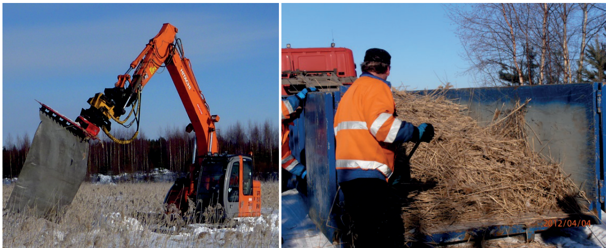
Kuva 23. JÄREÄ-hankkeessa tehdyn talviruo'on niiton kalustokokonaisuus oli vielä kokeiluasteella. Marjalan saaren edustan niitosta keväällä 2012 tullut tavara täytti 20 m 3 :n lavan vain osittain.
