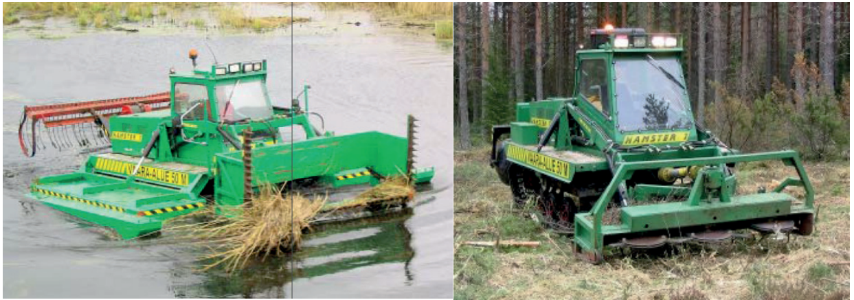
Kuva 10. Hamster 1 työskentelee sekä kuivalla maalla että vedessä. Kuvat: Koneyrittäjä 2/2006.
