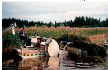
Kuva 8. Järviruo'on toimintaketjun alku, johon kuuluvat ruovikon leikkuu, massan keruu sekä nosto rannalle ja kuljettavan laitteen kyytiin sekä kuljetus jatkokäsittelyyn.
