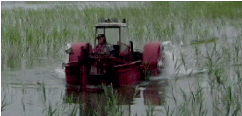
Kuva 14. Vesweed Oy:n kehittämiä niittokoneita. Vasemmanpuoleinen kone on nykyään valtimolaisen Taisto Tolvasen omistuksessa ja oikeanpuoleinen laite on Vesweed Oy:llä. Laite kerää niittomassaa kyytiin. Kuvat: Tiina Käki Pohjois-Karjalan ELY-keskus (vasen) ja Pyhäjokiseutu-lehti 22.5.2014.
