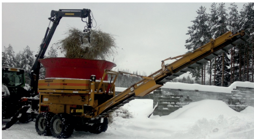
Kuva 38. JÄREÄ-hankkeen yhteistyökumppanit käyttivät talviruo'on silppuamiseen Haybuster-jauhinmurskainta. Kuva: Aimo Turunen.
