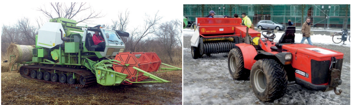
Kuva 21. Vasemmalla täysikasvuista ruovikkoa paalaava "Sumo-Quaxi" keväällä 2012 (Beckmann 2012) ja oikealla italialainen, pienetraktorin perään kytkettävä, kuutiopaalain M 60 Super (Abbiata).
