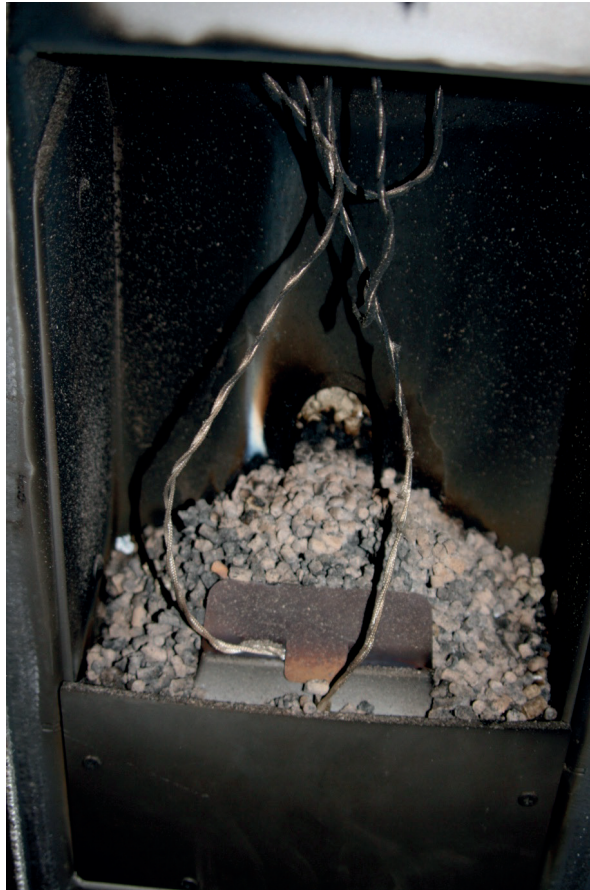
Kuva 45: Järviruokopelletin polttokokeen tulos Mekrijärven tutkimusasemalla. Kuva: Teemu Vilppo.
