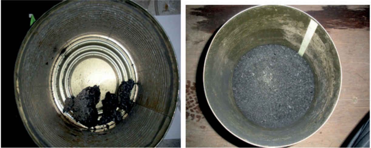
Kuva 46. Vasemman puoleisessa kuvassa polttoarinalle muodostunutta laavaantunutta materiaalia ja oikeassa kuvassa tyypillistä arinan alapuolelle pudonnutta tuhkaa. Kuva: Teemu Vilppo, Itä-Suomen yliopisto.
