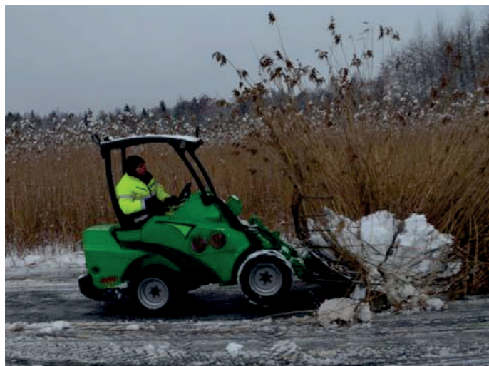
Kuva 18. Lahden Vesijärvellä käytetty talviruo'on niittoon soveltuva kone (Hot Mill Oy, Risto Kauhala). Kuva: Lahden Vesijärveltä Puhdas Vesijärvi-säätiön internet-sivuilta.
