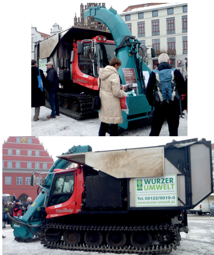
Kuva 40. Reed as a Renewable Resource-seminaarin (14–16.2.2013) yhteydessä esiteltiin järviruo'on niittoihin soveltuvaa kalustoa. Oheinen latukone silppuaa niittämänsä järviruo'on suoraan ja puhaltaa sen kyydissään olevaan konttiin.
