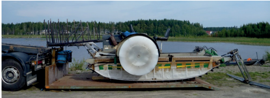
Kuva 15. Telapari Oy:n Truxor-alustainen niittokone. Leikkuupää on kuvassa oikealla ja niittomassan keruupää vasemmalla. Työntötehoa antaa lisää koneen sivuille lisätyt siipirattaat. Koneen tela-alusta mahdollistaa laitteen kulun jopa kuivalla maalla.
