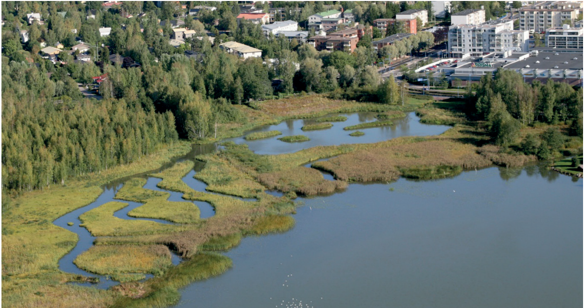
Kuva 31. Tuusulanjärven pohjoispäähän Loutinojan suulle Tuusulanjärven kunnostushankkeen yhteydessä rakennettu hulevesikosteikko lisää maiseman, linnuston ja muun eläimistön monimuotoisuutta. Kosteikon rannalla kulkee luontopolku, joka on nimetty edesmenneen luontoaktiivi Jouko Veikkolaisen muistoksi. Kuva: Tero Taponen, Uudenmaan ELY-keskus.
