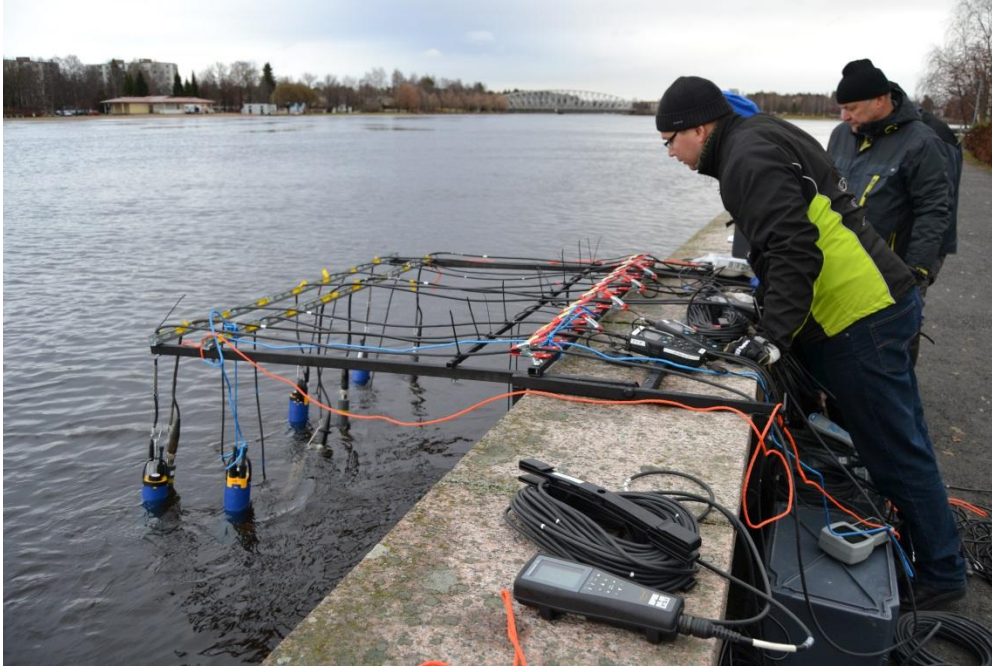
Kuva 1. Vertailumittaukseen osallistuneet kenttämittarit kiinnitettiin koetta varten rakennettuun anturitelineeseen. Anturitelineen avulla varmistettiin, että anturit olivat riittävän kaukana rannan betonireunasta, joka voimakkaasti virtaavassa vedessä olisi voinut rikkoa anturit. (Kuva T. Väisänen).
