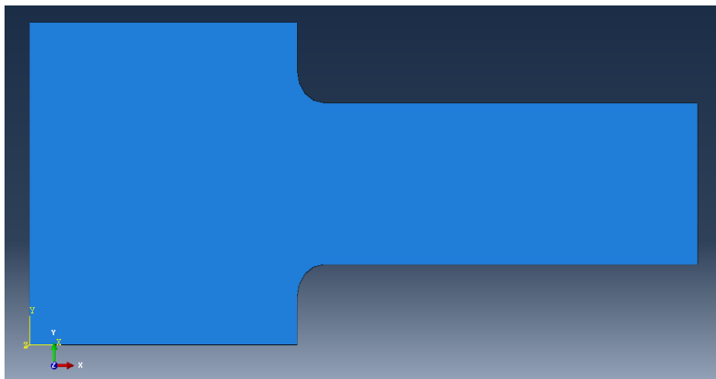
Gambar 4. Simulasi spesimen uji tarik ASTM D 638 tipe 4
