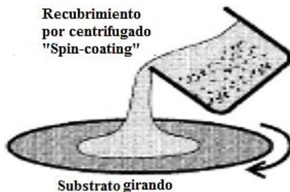
Figura 28. Depósito de capa de solución coloidal por "spin coating" [43].
