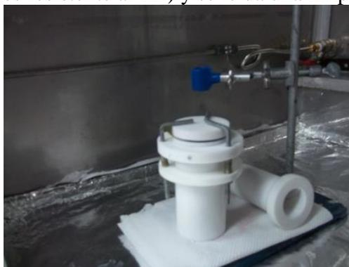
Figura A3. Celda electroquímica en forma externa.
