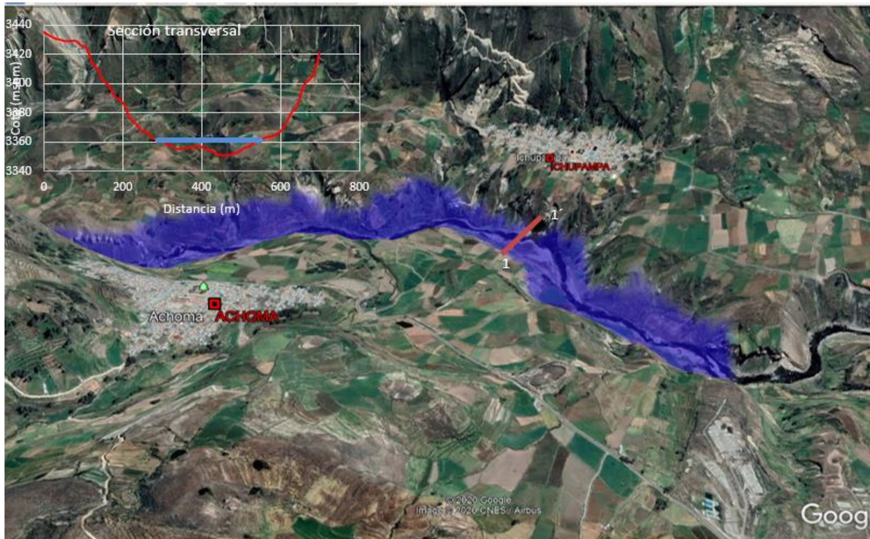
Figura 16. Profundidad de agua para un plano de HAND de 8m aguas debajo de del Dique Achoma (2). El la sección transversal corresponde del río corresponde al corte 1-1 Fuente: Google, Senamhi.
